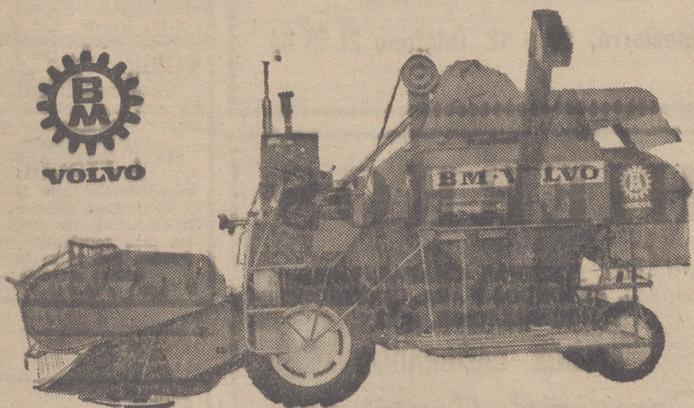
Nueva máquina equipada con tolva, ensacador, 2.ª limpia y desbarbador para cebada con tablero de corte de 7-8-10-12 y 14 pies
