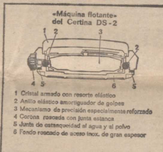
«Máquina flotante» del Certina DS-2
