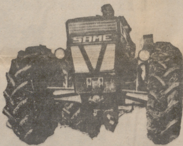
Tractor SAME, cuatro ruedas motrices, con motor Diesel de arranque instantáneo, refrigerado por aire.
