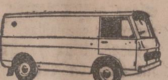
JEEP "FURGON DE REPARTO". - Peso en vacío: 1.560 kgs. Capacidad de carga: 6 m³ de capacidad y 1.000 kgs. de carga útil
