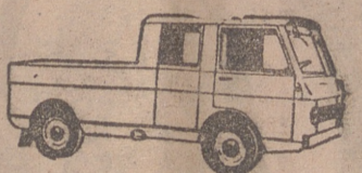
JEEP "DUPLIX". - Peso en vacío: 1.505 kgs. Capacidad de carga: 5 personas y 750 kgs.
