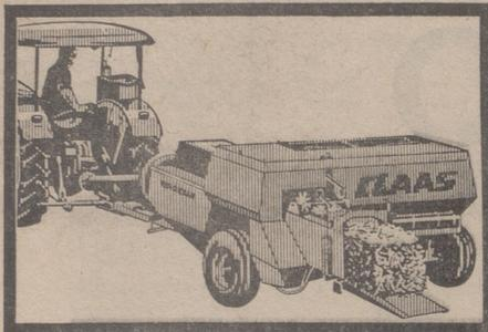
La empacadora CLAAS es una prensa recogedora-empacadora de alta presión. Trabajando según el sistema del pistón horizontal deslizante, consigue empacar toneladas de heno y paja en una hora.
