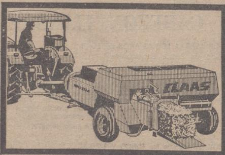
La empacadora CLAAS es una prensa recogedora-empacadora de alta presión. Trabajando según el sistema del pistón horizontal deslizante, consigue empacar toneladas de benu y paja en una hora. Y empaca con precisión! Todas las pacas que salen de la CLAAS son iguales, apretadas y bien atadas. Y un sistema especial hace que permanezcan así aunque se resequen.
