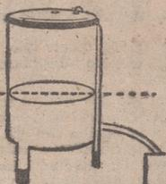
El vaciado de agua en una lavadora BRU se realiza normalmente sobre desagües situados por debajo del nivel mínimo de su contenido. Entonces queda la cuba totalmente vacía.
