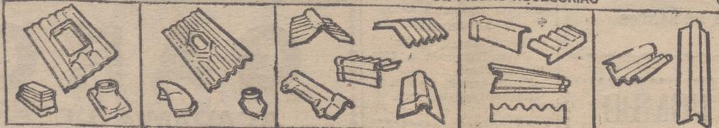
PLACA ONDULADA CLARABOYA Y SUS ACCESORIOS. PLACA ONDULADA SALIDA DE TUBO Y SUS ACCESORIOS. DIVERSOS TIPOS DE CABALLETES RIGIDOS Y ARTICULADOS. GERRAMIENTOS DE ALERO Y LATERALES. ENLACES A PAREDES LATERALES Y ENTRE VERTICALES.
