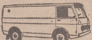
JEEP «FURGON DE REPARTO». —Peso en vacío: 1.560 kgs. Capacidad de carga: 6 m 3 de capacidad y 1.000 kgs. de carga útil.
