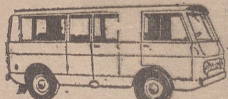
JEEP TOLEDO. —Peso en vacío: 1.575 kgs. Capacidad de carga: 9 personas ó 1.000 kgs. de carga útil.
