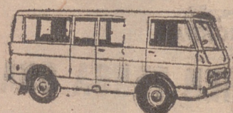
JEEP TOLEDO. • Peso en vacío: 1.575 kgs. Capacidad de carga: 9 personas ó 1.000 kgs. de carga útil.
