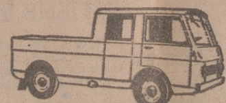
JEEP "DOPLEX".—Peso en vacío: 1.505 kgs. Capacidad de carga: 5 personas y 750 kgs.
